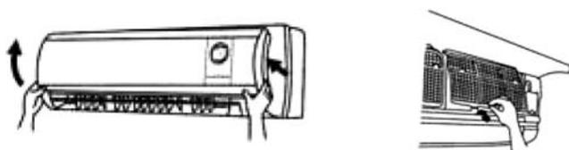
Le Bio filtre et le filtre au charbon actif sont fixés sur l'unité intérieure sous les filtres à air (modèles CSMCI 39 et CSMCI 51) ou sur des supports amovibles sur les filtres à air (modèle CSMCI 32).
