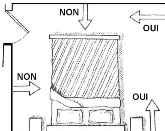
Bien entendu, il est des configurations qui ne permettent pas d'éviter de diriger les flux sur les personnes. Il faut alors orienter les ailettes de la sortie d'air de façon à avoir une gêne minimale.
