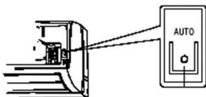
Utiliser une pointe fine pour presser le bouton. L'appareil fonctionne en mode automatique, la vitesse de ventilation et la température de consigne ne peuvent pas être modifiées. Une fois l'appareil démarré, refermer le panneau avant.
