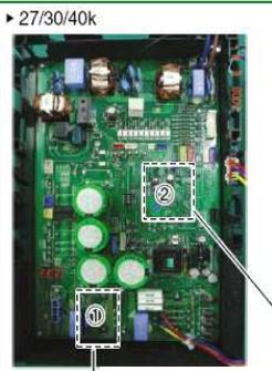
1 – Contrôler la connexion et la tension de CN\_P(L) et CN\_P(N) sur la carte principale ②
