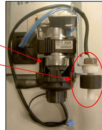
**Remarque:** la pompe sera alimenté des que l'unité extérieure sera en fonctionnement Si le flotteur reste plus de 6min en position haute (ouvert) le code erreur CH04 sera affiché
